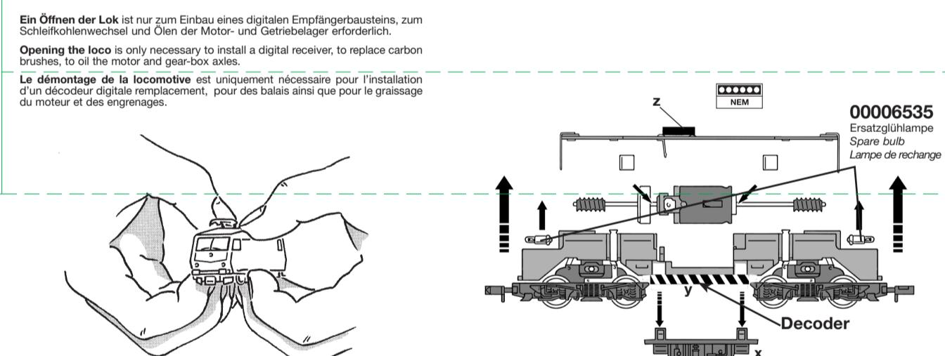
**Ein Öffnen der Lok** ist nur zum Einbau eines digitalen Empfängerbausteins, zum Schleifkohlenwechsel und Ölen der Motor- und Getriebelager erforderlich.
